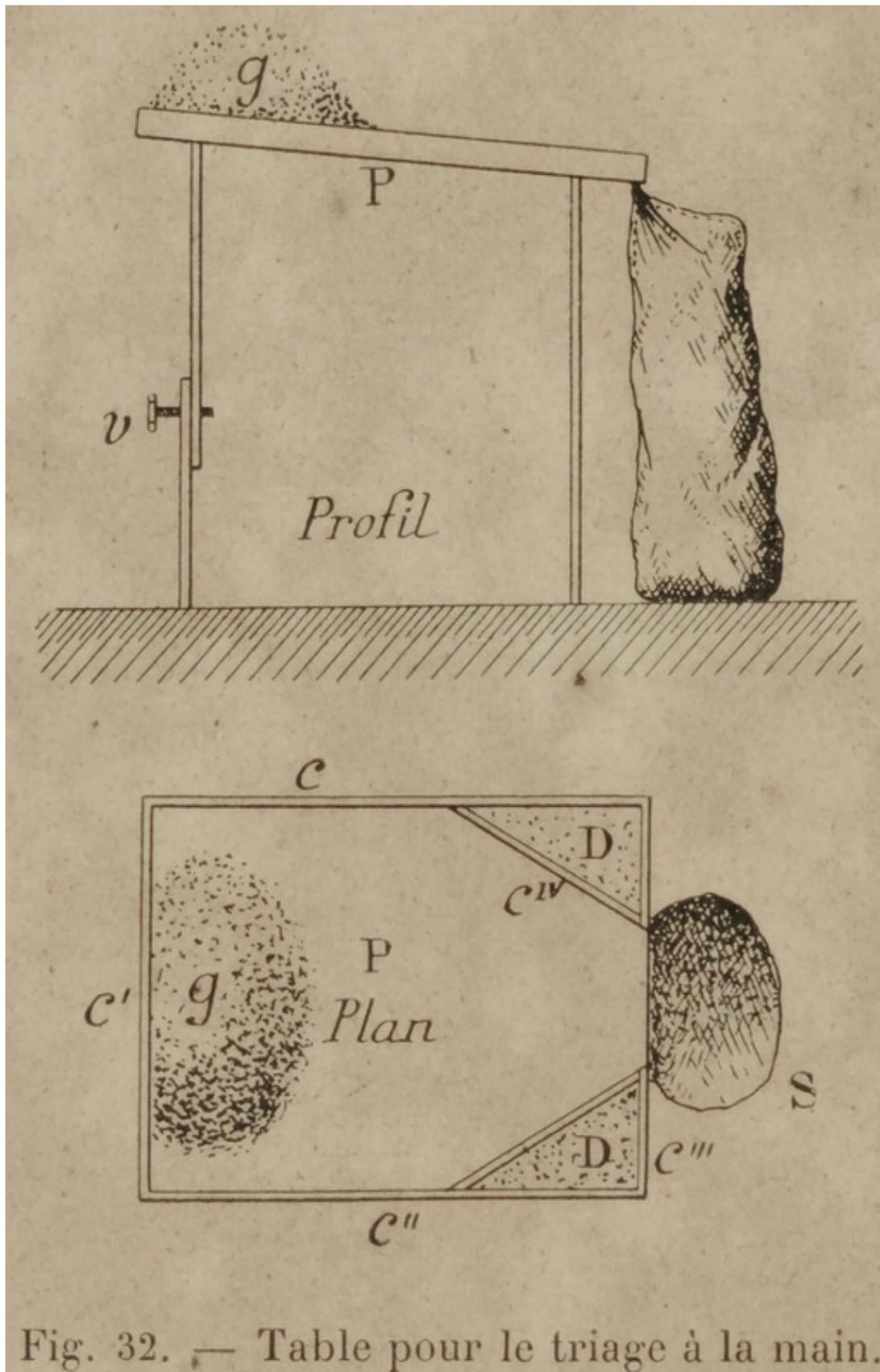
Fig. 32. — Table pour le triage à la main.
