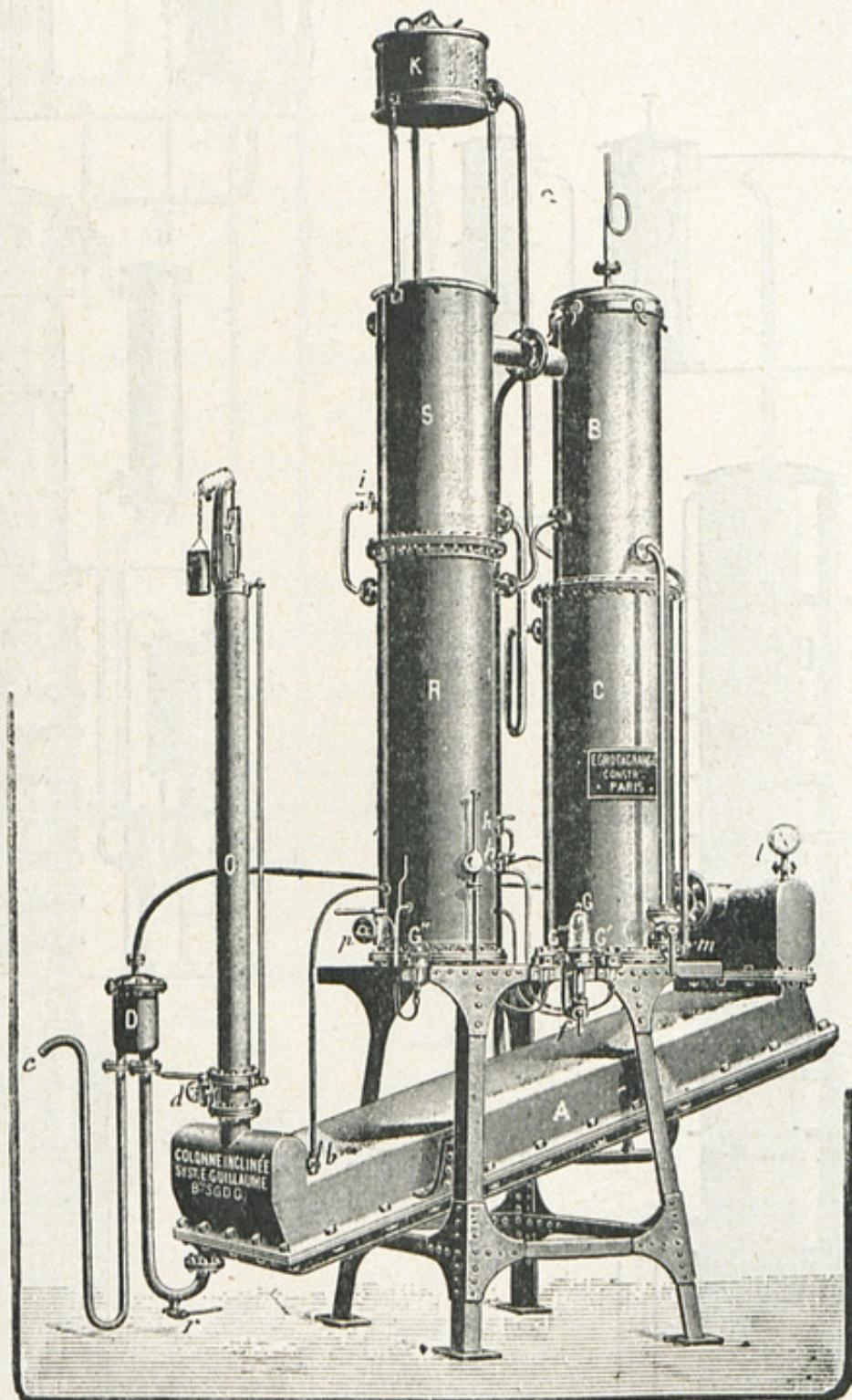
FIG. 76. — Appareil de distillation (système Guillaume).
