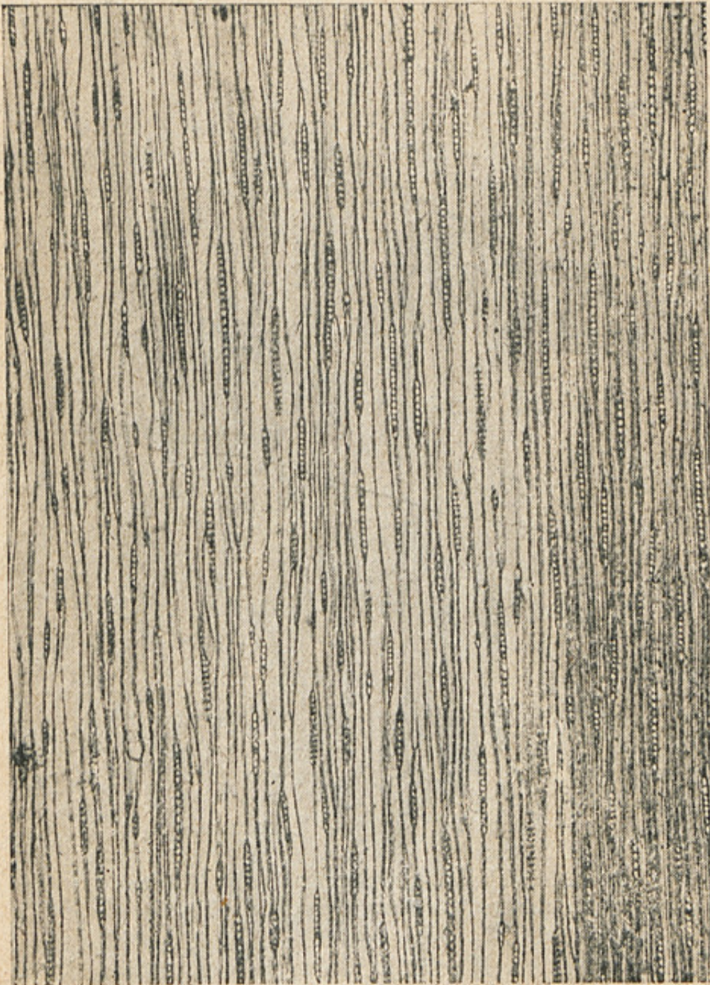
Fig. 10. — SECTION LONGITUDINALE DE BOIS de Ketleeria d'Indochine avec rayons constitués par une seule file de cellules. (Grossissement : 30 diam.)
