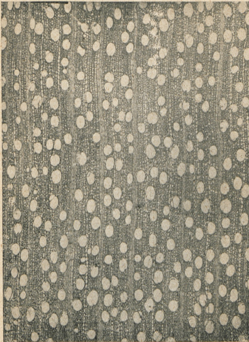
Fig. 13. — SECTION TRANSVERSALE D'UN BOIS de Weinmannia de Madagascar, sans zones d'accroissement et avec vaisseaux assez nombreux et sensiblement égaux. (Grossissement : 30 diam.)
