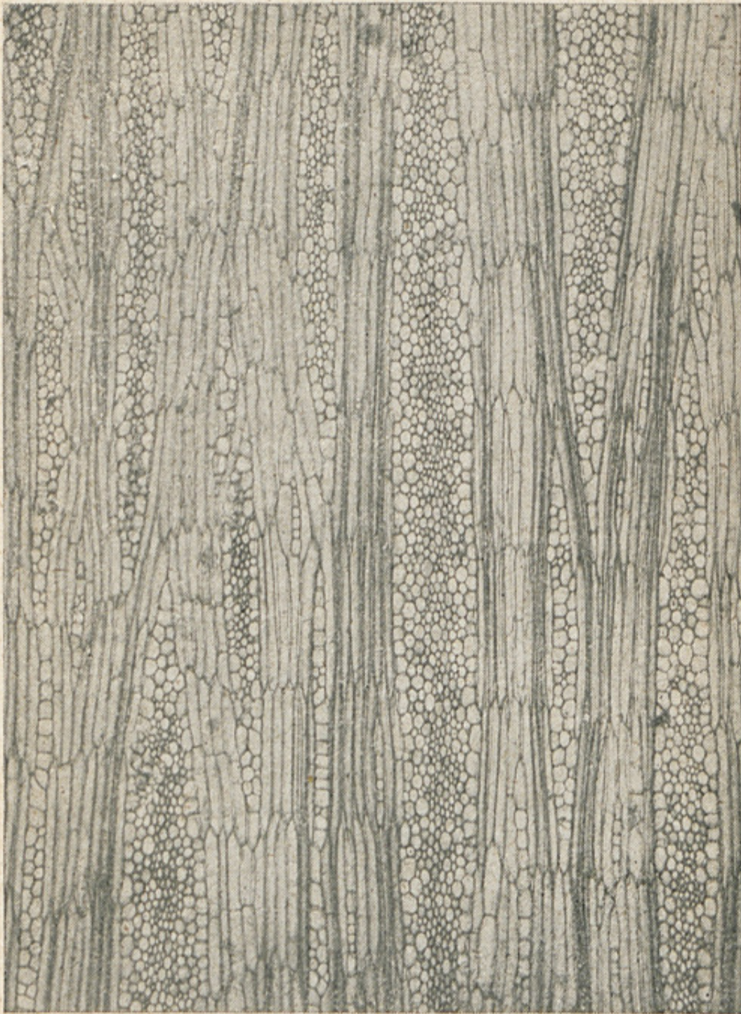
Fig. 21. — SECTION LONGITUDINALE TANGENTIELLE D'UN BOIS DE Sterculia avec rayons très grands et fibres étagées. (Grossissement : 30 diam.)
