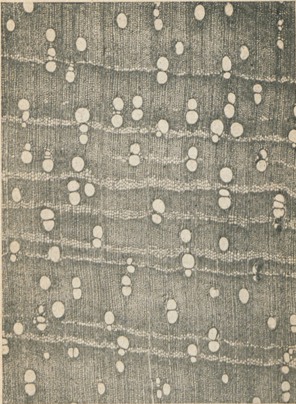
Fig. 25. — SECTION TRANSVERSALE D'UN BOIS DE Toddalia polymorpha P. Dang. (Rutacées) avec 8 zones principales de parenchyme ligneux circummédullaire. (Grossissement : 30 diam.)
