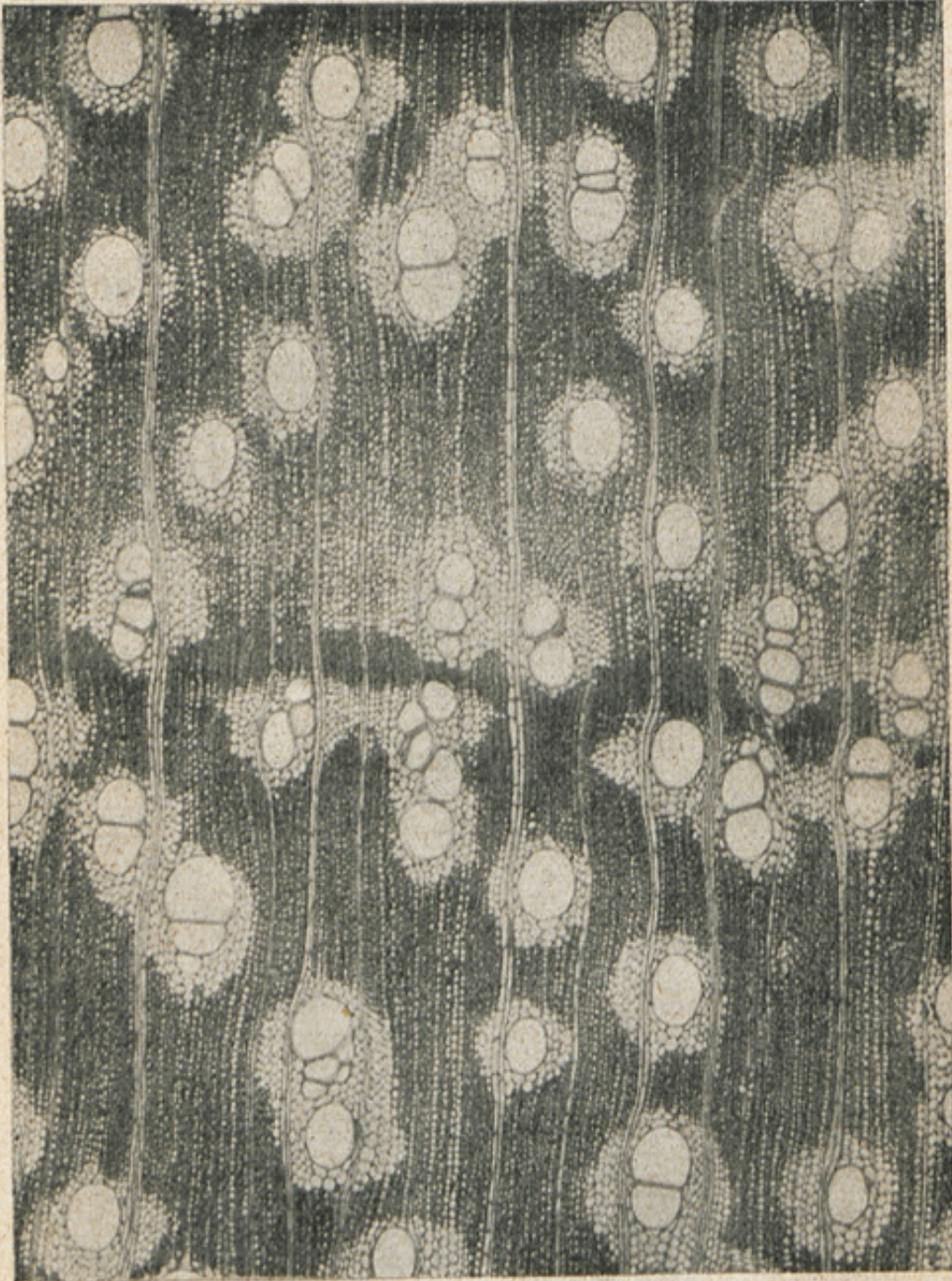
Fig. 27. — SECTION TRANSVERSALE D'UN BOIS DE Piptadenia Pervillei Vetke (Légumineuses-Mimosées), avec parenchyme ligneux circumvasculaire bien marqué. (Grossissement : 30 diam.)
